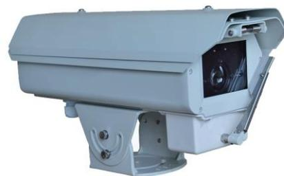
Фотометр ICB-22E измеряет уровень освещенности или яркости, создаваемый естественным светом на входе/выходе из туннеля, чтобы обеспечить визуальное восприятие водителей как днем, так и ночью, избегая внезапных колебаний уровней освещения и потенциального «эффекта черной дыры» при входе и выходе из туннеля.
